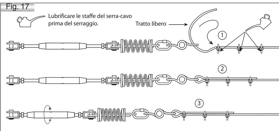
poi serrare a fondo i serra-cavi. Verificare che l'occhiello del cavo si allinei liberamente sul dissipatore.
