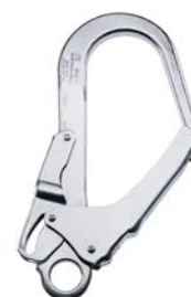
◀ MADP530 connettore in lega leggera con chiusura a doppia leva. Apertura 60 mm
